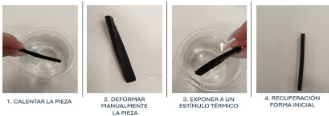
Funcionamiento de una aleación metálica inteligente
